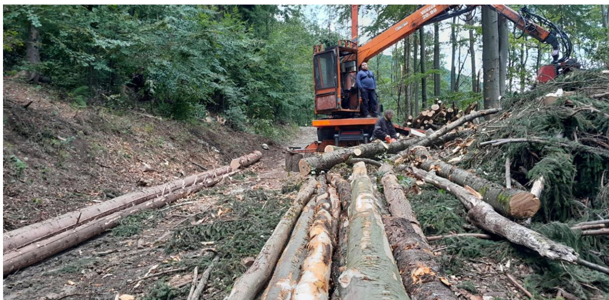
Spracovanie kalamitného dreva lanovými systémami
